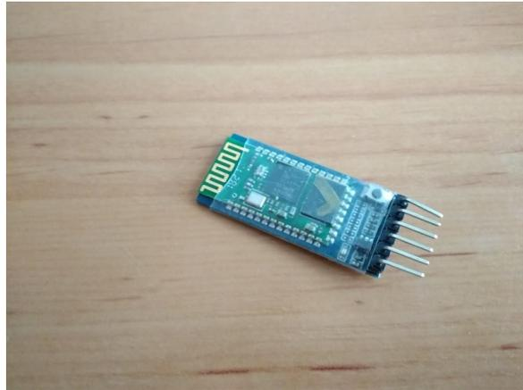
*Ilustración 8: El uso de un módulo Bluetooth permitirá a los usuarios más avanzados comunicarse inalámbricamente con el robot*
