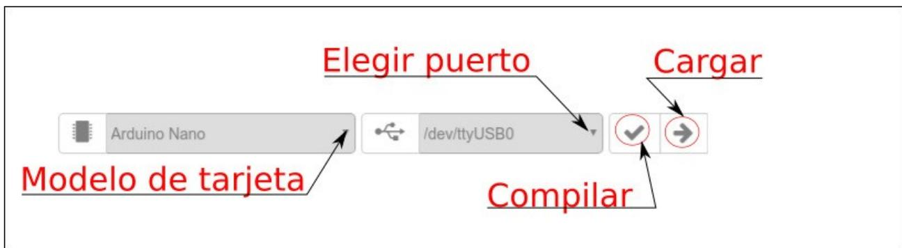
*Ilustración 11: Detalle de MasayloBlockly: elección de tarjeta y puerto, botones de compilado y volcado*
